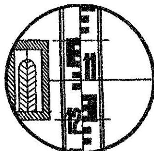
9. Снимите отсчет по вертикальному кругу теодолита
