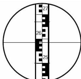
8. Определите расстояние от прибора до рейки
